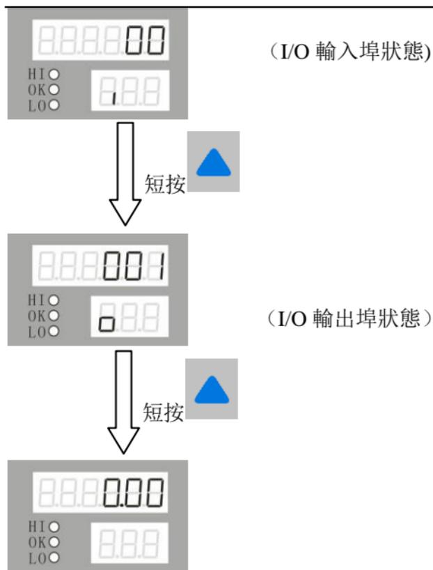
注 7. 零點、穩定狀態顯示注釋（下排數碼管顯示）
